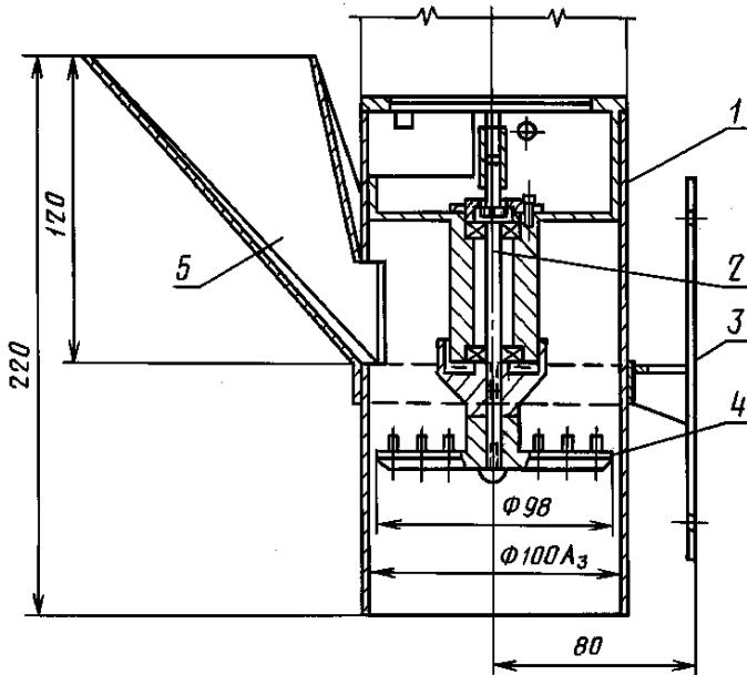
Фторопласт-4 подают небольшими порциями на вращающийся диск рыхлителя и сквозь зазор между корпусом и диском он ссыпается в виде порошка в тару-приемник.
